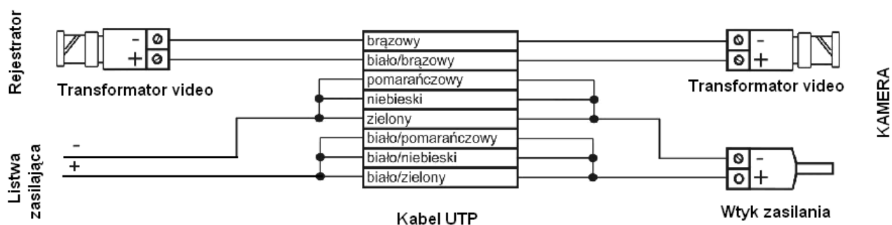
Rysunek 4. Schemat połączenia kamery z rejestratorem poprzez pasywny transformator video
