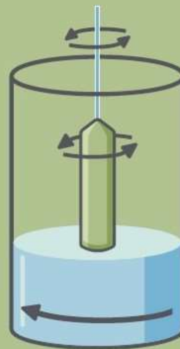
WYCIĄGANIE KRYSTAŁU Z FAZY CIEKŁEJ, OBRACANIE PRĘTA
